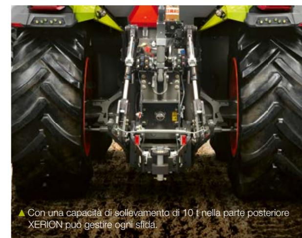
▲ Con una capacità di sollevamento di 10 t nella parte posteriore XERION può gestire ogni sfida.
