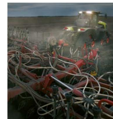
▲ Un ampio allestimento idraulico con una portata fino a 537 l/min e otto distributori offrono la massima flessibilità ed efficienza sul mercato.
