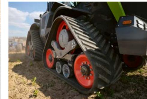
◀ Cingoli di due larghezze diverse (914 mm o 762 mm) assicurano il massimo rispetto del suolo. Con i cingoli più stretti XERION presenta una larghezza inferiore a 3 m.
