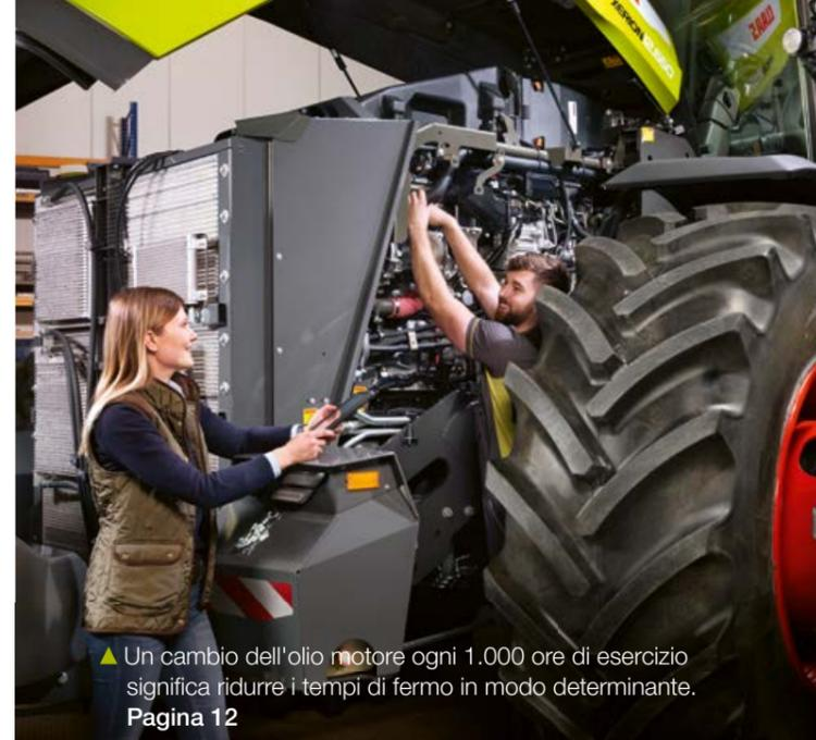
▲ Un cambio dell'olio motore ogni 1.000 ore di esercizio significa ridurre i tempi di fermo in modo determinante.
