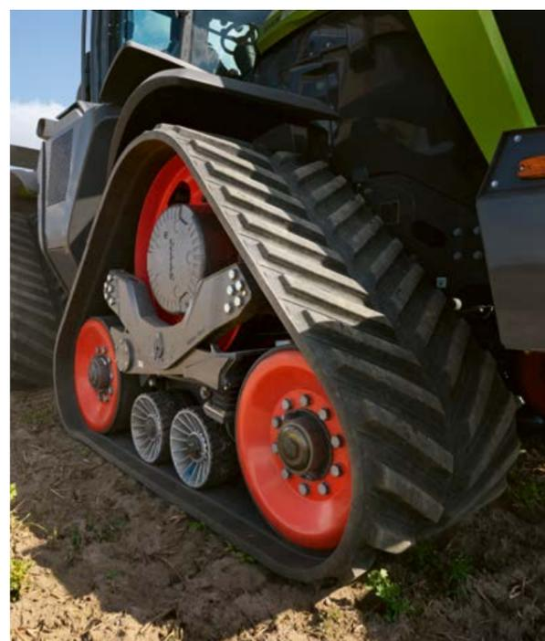
▼ «La cingolatura TERRA TRAC, sviluppata appositamente da CLAAS per XERION, trasmette la potenza al suolo in modo efficiente e delicato».
